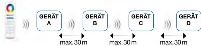
Automatischen Signalübertragung: ein Gerät reagiert auf eine Sendemodus-Anweisung und kann den Befehl an weitere Geräte (max. 30m entfernt) übertragen. So können auch Geräte gesteuert werden, die sich in weiterer Entfernung zur Signalquelle befinden. Eine automatische Synchronisation sorgt außerdem für die gleichen Einstellungen bei allen verbundenen, laufenden Geräten.
