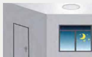
Nach Stand-By-Zeit wird das Licht ausgeschaltet, solange keine neue Bewegung erkannt wird.
