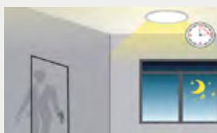
Nach Haltezeit wird das Licht schrittweise auf ein geringeres Lichtlevel gedimmt, solange keine neue Bewegung erkannt wird.
