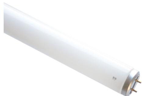
Leuchtstofflampe T12 38x590 mm Lampe emittiert UV-Strahlung im Bereich 315-400nm mit einem Maximum bei 352nm. Anwendungen: Insektenfallen, Diazotypie (Lichtpausverfahren), Chemische Prozesse, z. B. Polymerisation, Erkennung ...
