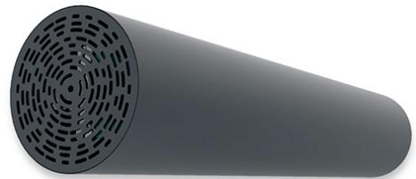
UV-Desinfektionsleuchte 1300mm Installation: Wand, Decke, Ständer, für 24-h-Luftdesinfektion, Ventilatorleistung: 117 qm/h, Austausch der UV-C Lampe: 1x/Jahr, Austausch Luftfilter ca. 2x/Jahr, inkl. 2 x 30 W ...
