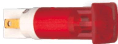
LED-Signalleuchte 10mm Funktions-Anzeige, Einbau-Durchmesser 10mm für Snap-in Befestigung mit super- und ultrahellen LEDs. Geeignet für Plattenstärken ab 1,5mm. Vollwinkel: 15°. Flache, oberflächenmatte Blendköpfe mit sehr ...
