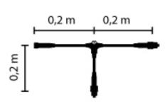
Quick Fix T-Verbinder Verbindungskabel m.2 Ausgäng Quick Fix Divider 2, T-Verbinder mit transparentem Kabel, Verteilerkabel mit 2 Ausgängen, max.Belastbarkeit 200W
