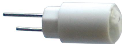
Chip-LED 5,6x10mm Spezielle Kombination aus Reflektor und Streulinse. Dadurch wird eine Abstrahlcharakteristik ähnlich einer Mehr-Chip LED erreicht. Kunststoffkörper (Reflektor) mit Farbring in Leuchtfarbe. Integrierter Vorwiderstand, ...
