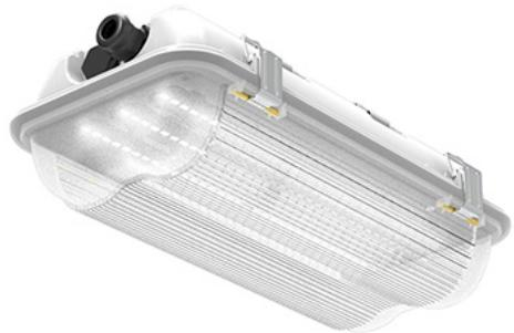
Notleuchte zur Aufsteck- u. Hängemontage, ATEX 22, PC Gehäuse grau RAL7035, EPDM Dichtung, IK10. Notbeleuchtung 1h bei 2.4W.
