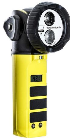
Einsatz in gas- u. staubexplosionsgefährdeten Bereichen (Ex-Zonen 0, 1, 2, 21, 22), Power-Akku mit extra langer Lebensdauer, Leuchtweite ca. 300m, 90° schwenkbar, Akku: Lithium-Ionen-Akku 3,7V/4,6Ah. ...
