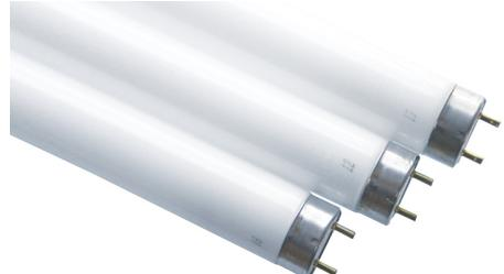
Leuchtstofflampe T8 26x330 mm Für Insektenvernichter geeignet. Lampe emittiert UV-Strahlung im Bereich 315-400nm mit einem Maximum bei 352nm. Anwendungen: Insektenfallen, Diazotypie (Lichtpausverfahren), Chemische Prozesse, z. ...
