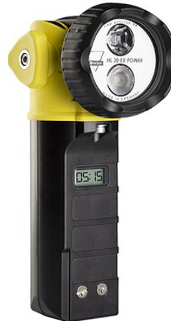
Einsatz in gas- u. staubexplosionsgefährdeten Bereichen (Ex-Zonen 1, 2, 21, 22), Leuchtweite ca. 250m, 90° schwenkbar, Akku: Lithium-Ionen-Akku 3,7V/4,6Ah. Hauptlampe 4,5W-Power LED mit 420 lm, ...
