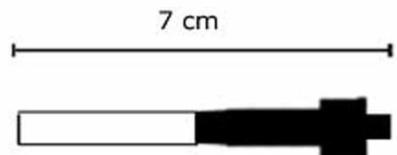
Adapter für QuickFix-Verbinder f.Lichtschlauch Adapter: Lichtschlauch an QuickFix transparent mit Endkappe, Lösungsmittelkleber, Einspeisepin und 2 Schrumpfschläuchen, max. Belastbarkeit 740W
