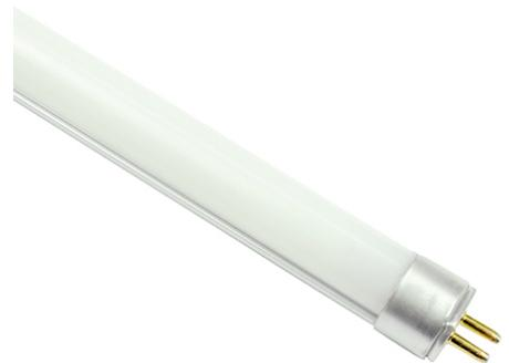
Leuchtstofflampe 16x212mm Leuchtstofflampe T5 Standard, 16mm Durchmesser, G5, hellweiß. Die T5-Lampen haben eine höhere Lichtausbeute als die bisherigen T8-Fabrikate. Quecksilbergehalt (mg): 2.5 Schaltzyklen: 30000 Zündzeit/Startzeit ...
