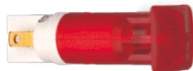
LED-Signalleuchte 10mm Funktions-Anzeige, Einbau-Durchmesser 10mm für Snap-in Befestigung mit super- und ultrahellen LEDs. Geeignet für Plattenstärken ab 1,5mm. Vollwinkel: 15°. Flache, oberflächenmatte Blendköpfe mit sehr ...
