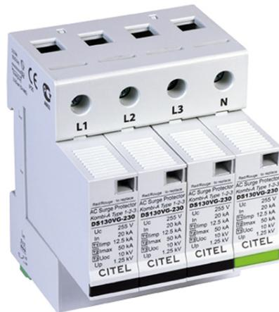
Kombi-Ableiter DS134VGS-230/G Diese neue Reihe mit 12,5kA Ableitvermögen pro Pol ist eine platzsparende und günstige Lösung für Gebäude der Blitzschutzklassen III+IV. Durch die integrierte VG-Technolgy ...
