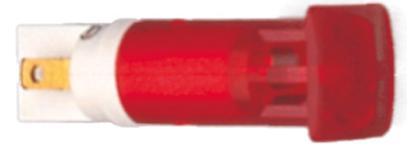
LED-Signalleuchte 10mm Funktions-Anzeige, Einbau-Durchmesser 10mm für Snap-in Befestigung mit super- und ultrahellen LEDs. Geeignet für Plattenstärken ab 1,5mm. Vollwinkel: 15°. Fläche, oberflächenmatte Blendköpfe mit sehr ...
