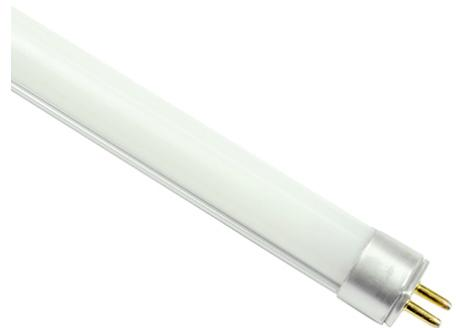
Leuchtstofflampe 16x288mm Für Insektenvernichter geeignet. Lampe emittiert UV-Strahlung im Bereich 315-400nm mit einem Maximum bei 352nm. Anwendungen: Insektenfallen, Diazotypie (Lichtpausverfahren), Chemische Prozesse, z. B. Polymerisation, ...
